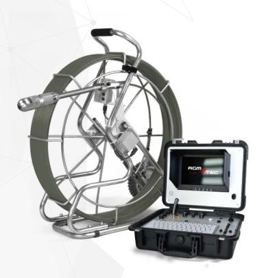
La Tubicam® XL 360 HAD est une caméra d'inspection de canalisations rotative, dont la tête de caméra est dirigeable depuis la console. Grâce à sa focale et son éclairage puissant, elle permet d'inspecter un large panel de réseaux du Ø60 mm au Ø800 mm.
